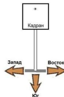
Рис. 14.2. Ориентирование кадрана вертикальных солнечных часов
