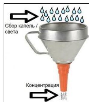
Рис. 48.3. Сравнение воронки с собирающей линзой
