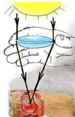
Рис. 48.1. Действие собирающей линзы
