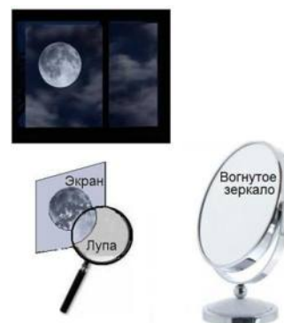
Рис. 50.2. Демонстрация принципа действия телескопа-рефлектора
