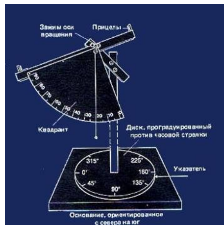
Рис. 10.7. Схема угломерного инструмента для измерения высоты и азимута светила
