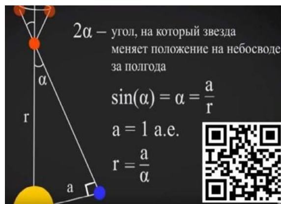
Рис. 32.4. Определение расстояний до звезд методом годичного параллакса (видео 40 с)
