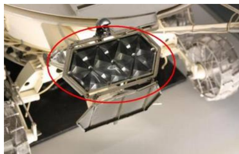
Рис.33.3. Уголковый лазерный отражатель, установленный на «Луноходе-1»
