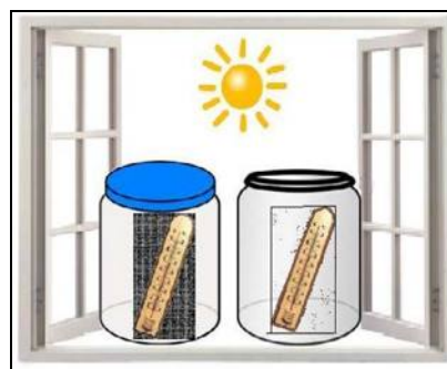
Рис. 38.1. Эксперимент по наблюдению парникового эффекта
