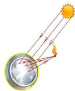
Рис. 48.2. Действие вогнутого зеркала аналогично собирающей линзе
