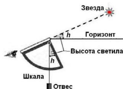
Рис. 10.4. Сборка модели квадранта
