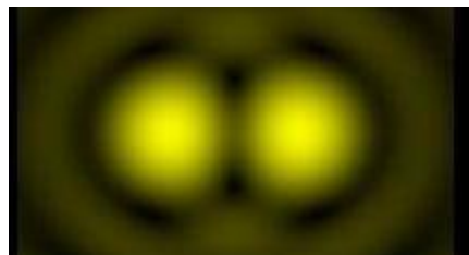
Рис. 49.6. Дифракционная картина двух рядом расположенных звезд
