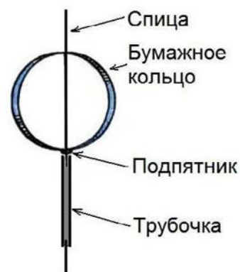
Рис. 30.1. Изготовление прибора для демонстрации сжатия Земли
