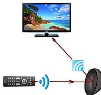
Рис. 51.3. Отражение сигнала пульта управления телевизором от импровизированной «антенны»
